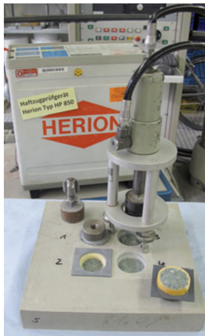
Prüfung der Oberflächenzugfestigkeit
