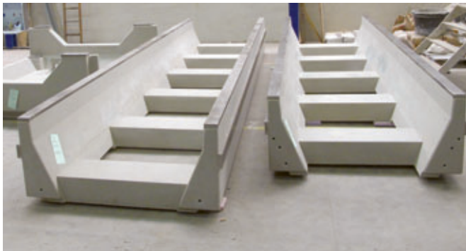
Betonkörper eines Maschinenbettes
