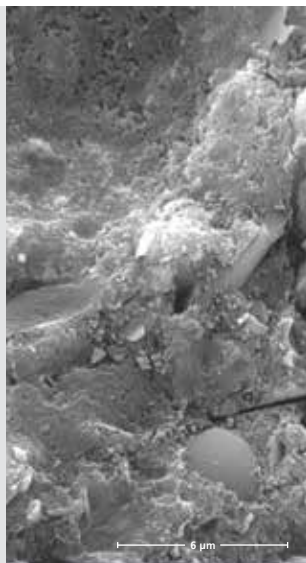
Elektronenmikroskopaufnahme: Beton mit MIKRODUR-Technologie
