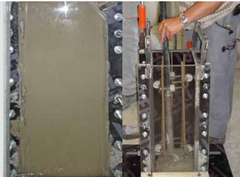
Einsatz der Prüfschalung im Betonlabor des Wilhelm-Dyckerhoff-Institutes zur Beurteilung von Fließ- und Verdichtungsverhalten sowie optischer Qualität der Betonkontaktzone.
