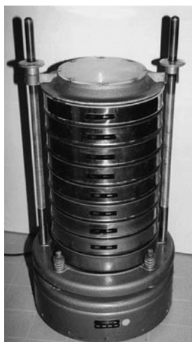
Bild 6: Siebmaschine nach DIN EN 933-1
