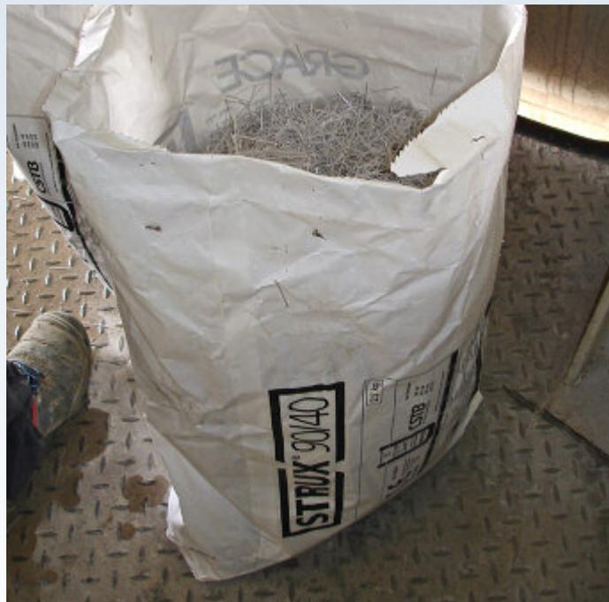
Bild 3: Die alkalibeständigen Makro Strux Kunststofffasern
