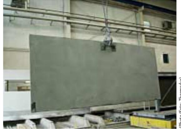
Fig. 7 Façade panel 4.50 m x 1.85 m x 0.02 m
