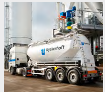
Zementversand mit Silo-LKW
