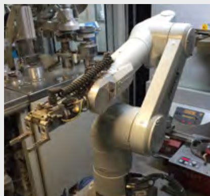
Laborroboter in der automatisierten Qualitätskontrolle
