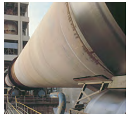
Drehofen und Wärmetauscher
